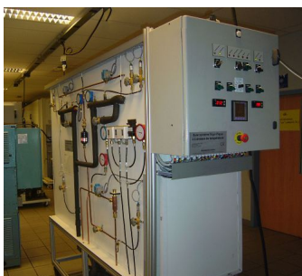
Système frigorifique avec le pupitre de commande et le circuit du fluide
